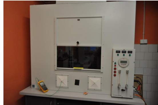
Komora do badań palności wg UL-94
