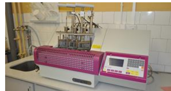
Aparat do pomiaru odporności cieplnej wg Vicata i HDT
